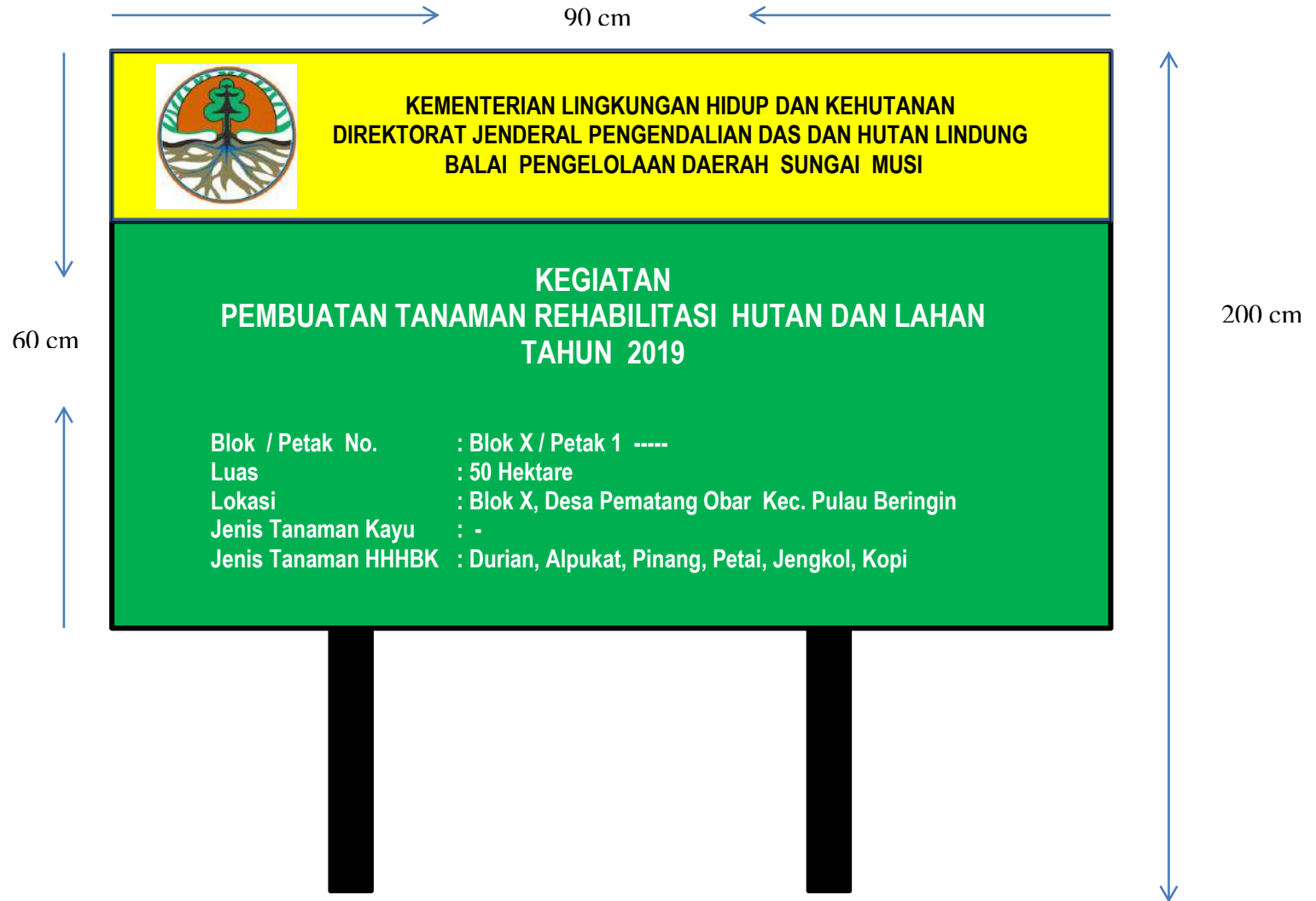
Gambar 1. Design dan ukuran papan nama petak
