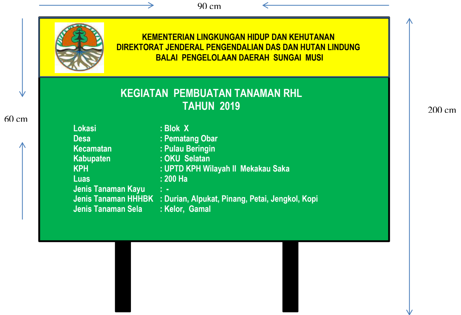
Gambar 2. Design dan ukuran papan nama blok
